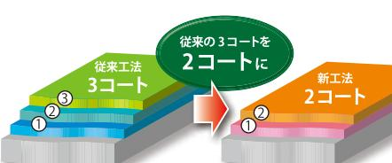
◎KFスーパーセラ P200、YP200 ルーフ 各改修下地に対して、強い密着力と上塗り塗料に対し最適な下地を形成します。改修下地を選ばません。(リシン基材第一部の基材には下地調整材の仕様を推奨)
