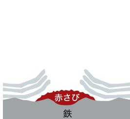
さびが塗膜を押し上げ、塗膜の下
