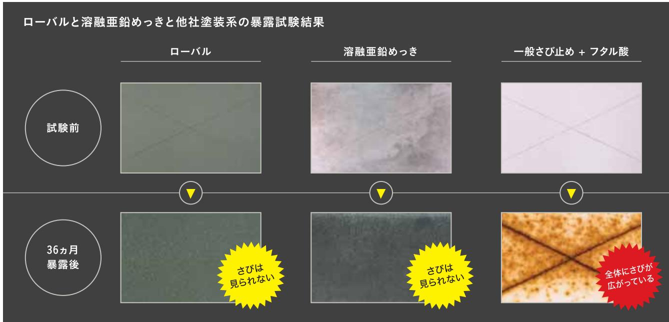
(一財)日本ウェザリングテストセンター宮古島試験場にて36ヵ月間暴露を行った試験結果です。一般さび止めを用いた塗装系では傷部(クロスカット部)から発生したさびが塗膜の下で進行し、全体に広がっているのに対し、ローバルおよび溶融亜鉛めっきは傷部からのさびの進行を抑え、犠牲防食作用が働いていることが確認できます。
